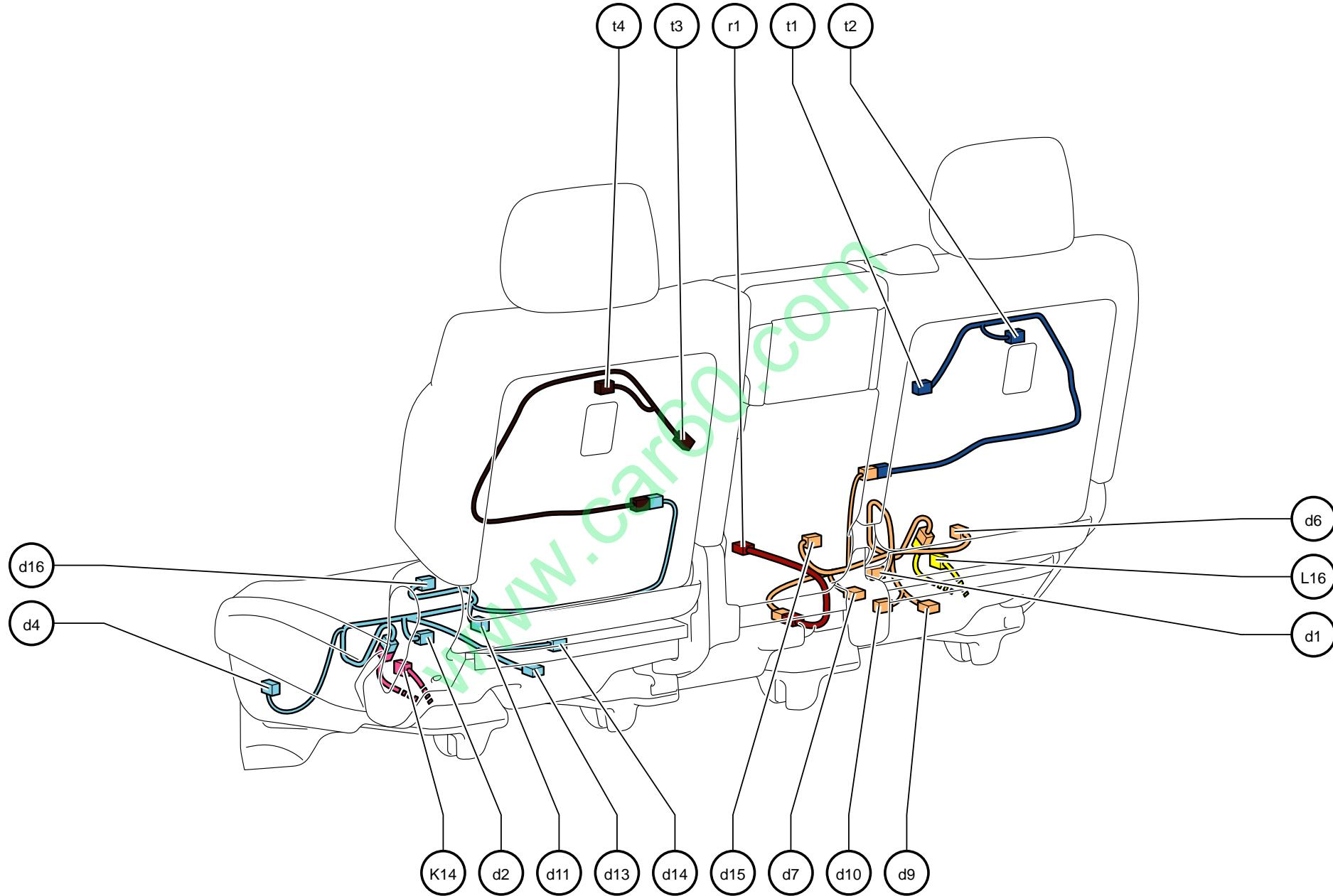
K14 后排左侧侧空气囊点火管电路
